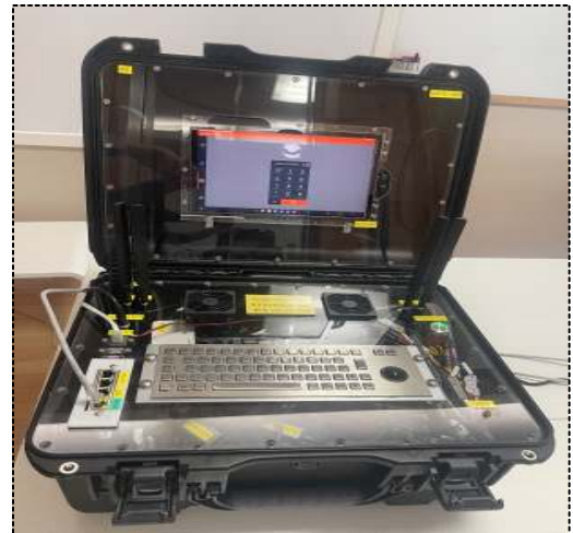
그림 5. All-in-One 비상통신망 Kit 노드 시작품 Fig. 5. All-in-One Emergency Communication Kit PoC System
